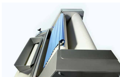
Cambio de cinta rápido y sencillo sin desarmado de la máquina.
