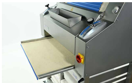
Placa de recogida de acero inoxidable recubierta fieltro de lana en guías.
