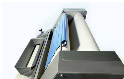
Changement de tapis rapide et facile sans démontage de la machine.
