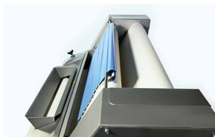
Einfacher und schneller Austausch von Bändern; leicht zugänglich in der Maschine.
