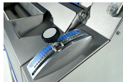
Ergonomisch geplaatste hendels voor het nauwkeurig instellen van de rolwalsen.
