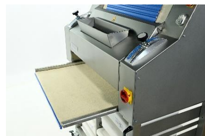
Ausziehbare Sammelplatte mit leicht auswechselbarem Wollfilzbezug.
