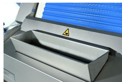
Federnder Teigzufuhr aus rostfreiem Stahl mit Sicherheitsschalter
