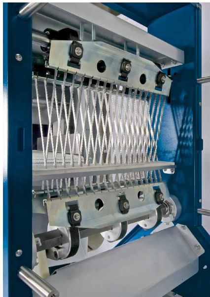
Système de tranchage croisé, unique et éprouvé avec des lames inclinées qui durent jusqu'à trois fois plus longtemps.
