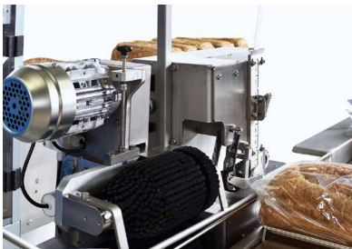
Rodillo de cepillado para alisar el saco antes de cerrarlo.
