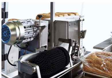
Bürstenwalz zum Glattstreichen des Beutels vor dem Verschließen.
