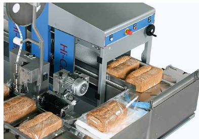
Después de cortar el pan en rebanadas, un dispositivo soplador de bolsas abrirá automáticamente la bolsa de plástico.
