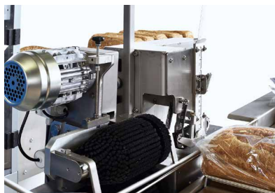
Щеточные валики для разглаживания пакета перед закрытием.
