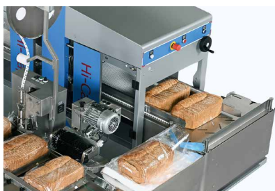
Après le tranchage du pain, une souffeuse à sacs ouvre le sac en plastique en le gonflant d'air.
