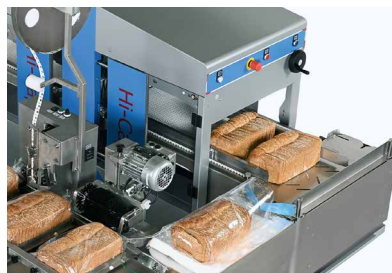
Nach dem Schneiden des Brots öffnet der Beutelloffner den Plastikbeutel automatisch.
