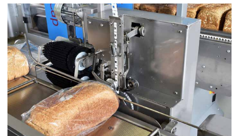
Beuterverschluss mit Clip, Clipband oder Klebeband.
