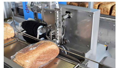
Zaksluitsysteem met clip, clipband of tape.
