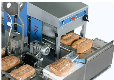
После нарезки хлеба устройство раздува пакетов автоматически открывает пластиковый пакет.
