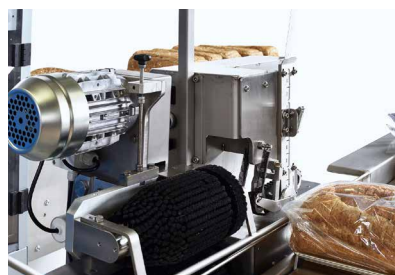
Brosse à rouleaux pour lisser le sac avant la fermeture.
