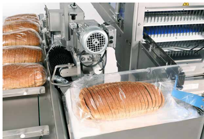
Après le tranchage du pain, une souffeuse à sacs ouvre le sac en plastique en le gonflant d'air.
