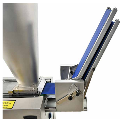
Optional mit doppeltem Ausgabeförderband / Höhenförderer für Ausgabehöhe bis max. 195 cm.
