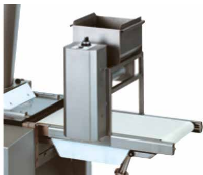
Automatischer Mehlstreuer aus Edelstahl mit präziser kontinuierlicher oder Intervall-Mehldosierung (Option).
