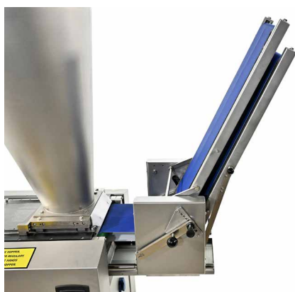
Automatische RVS meelstrooier met continue of interval bestrooiing van afgewogen deegstukken (optie).
