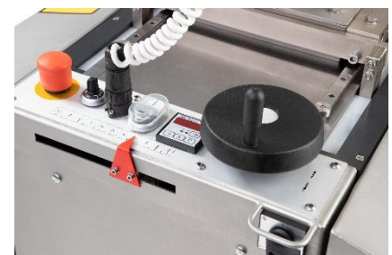
De SLIM afweger is ontworpen voor dagelijks intensief gebruik. Uitgerust met een elektronisch instelbare snelheidsregelaar en (dag)teller.
