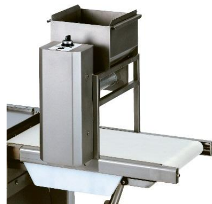
Automatische RVS meelstrooier met continue of interval bestrooiing van afgewogen deegstukken (optie).
