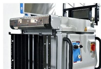
Frontgriffe zum Schutz des Bedienfelds und erhöhte Mobilität
