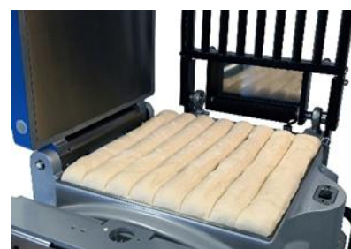
Placa y cuadrícula de moldeado para 6, 8 y 10 baguettes.
