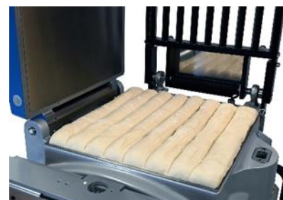
Формовочная пластина и формовочная решетка для 6, 8 или 10 багетов.
