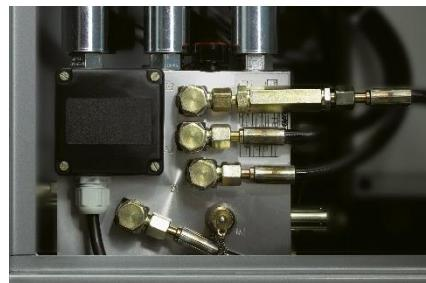
Einstellbare Hydraulikdruckregelung für maximale Flexibilität bei der Verarbeitung zahlreicher Teigarten.
