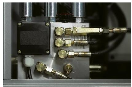
Régulation de la pression hydraulique variable pour une flexibilité accrue et un vaste choix de types de pâte.
