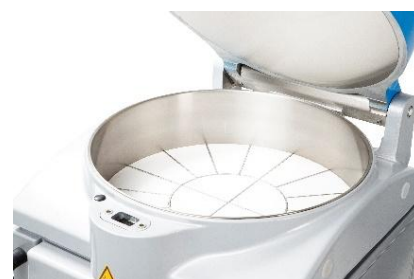
Cabezal divisor de segmentos divisores Ertalyte de uso alimentario.
