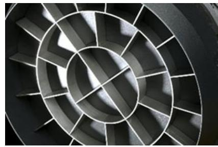
Een geanodiseerde aluminium verdeelschijf met een hoogwaardig RVS mes staan garant voor een hoge mate van hygiëne. Bij het verdelen en opbollen is weinig meel nodig.
