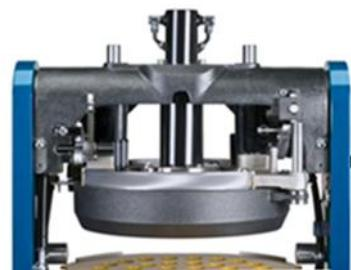
De verdeelschijf past de persdruk automatisch aan. De DR Robot is uitgerust met betrouwbare en gedegen elektronica evenals een stil en duurzaam hydraulisch systeem dat ook bij een lage olietemperatuur goed functioneert.
