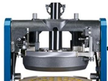
De verdeelschijf past de persdruk automatisch aan. De DR Robot is uitgerust met betrouwbare en gedegen elektronica evenals een stil en duurzaam hydraulisch systeem dat ook bij een lage olietemperatuur goed functioneert.
