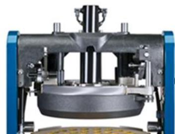
Le système de division à basse pression respecte la pâte et ne demande pas d'effort physique de la part de l'opérateur. Le Robot DR est équipé d'une électronique fiable et éprouvée et d'un système hydraulique silencieux et durable avec une température de fonctionnement basse.
