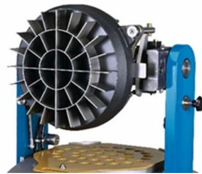
Der einzigartige und leicht zu bedienende Mechanismus klapt die Teileinheit mühelos hoch, um bei der täglichen Reinigung Zeit zu sparen.
