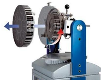
Die auswechselbaren Teilscheiben (Umrüstzeit: 5 min) bieten eine hohe Flexibilität für Teiglinge zwischen 16 und 440 g. Die Scheiben lassen sich für eine einfache Reinigung nach oben/vorne klappen.
