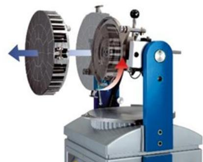
Le disque diviseur interchangeable (en moins de 5 minutes) offre une flexibilité accrue, une plage de travail de 16 à 440 g et bascule vers l'avant pour un nettoyage facile.
