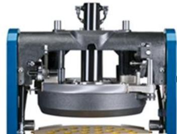
Разделительная система низкого давления бережно работает с тестом и не требует от оператора физических усилий. Модель DR Robot оснащена надежной проверенной электроникой, а также бесшумной и долговечной гидравликой с низкой рабочей температурой.
