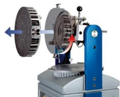
El disco divisor intercambiable (en 5 minutos) ofrece mayor flexibilidad, un ámbito de trabajo de 16 - 440 gr y se inclina hacia adelante para facilitar la limpieza.
