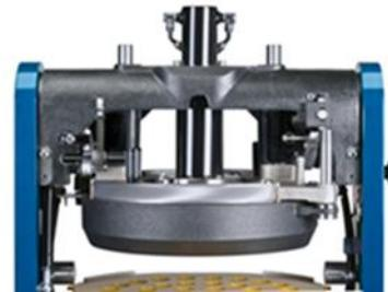
El sistema divisor de baja presión cuida la masa y no requiere esfuerzo físico alguno del operador. El DR Robot incorpora una electrónica fiable y probada y una hidráulica diseñada especialmente, silenciosa y de larga vida, con temperatura baja de funcionamiento.
