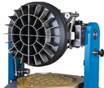
Уникальная система наклона вперед для простого открытия, удобной и безопасной очистки, экономящая время.
