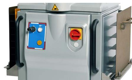
Прессовочные пластины и формовочные решетки можно установить в одну из двух опор формовочной решетки на обеих сторонах машины. Формовочные решетки выполнены из нержавеющей стали и имеют тефлоновое покрытие.
