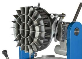
Sistema de inclinación hacia delante fácil y exclusivo que permite limpiar el conjunto divisor robusto sin esfuerzo, ahorrando tiempo cada día.
