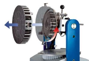
El disco divisor intercambiable (en 5 minutos) ofrece mayor flexibilidad, un ámbito de trabajo de 16 - 440 gr y se inclina hacia adelante para facilitar la limpieza.
