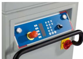
Con la Variomatic la calidad del producto incrementa debido a los parámetros adicionales que emparejan los discos divisores con el tipo de masa: velocidad y recorrido de redondeo. El ajuste de peso se programa en el panel de control.
