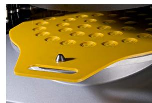
Alle Teigteiler und Rundwirker von Daub werden standardmäßig mit drei Rundwirkplatten aus Kunststoff geliefert.
