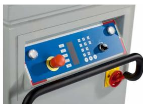
Beim Modell Variomatic wird die Produktqualität durch zusätzliche Parameter, mit denen Teilscheiben und Teigtyp aufeinander abgestimmt werden (Rundwirkdrehzahl und -hub), weiter gesteigert. Die Gewichtseinstellung kann über das Bedienfeld programmiert werden.
