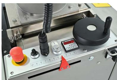
La SLIM Globe está diseñada para uso diario. La máquina está equipada con regulador de velocidad electrónico y contador de piezas.
