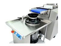
Falls gewünscht kann der Rundwirker ganz einfach getrennt werden und als separate Maschine für bis zu 2400 Stück (20 bis 1700 g) pro Stunde betrieben werden.
