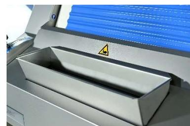
Откидной защитный бункер из нержавеющей стали на подаче теста.
