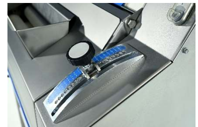
Ergonomisch platzierte Hebel für eine präzise Positionierung und Einstellung von Zufuhr und Bandrollen.
