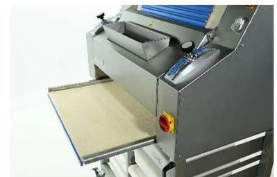
Ausziehbare Sammelplatte mit leicht auswechselbarem Wollfilzbezug.
