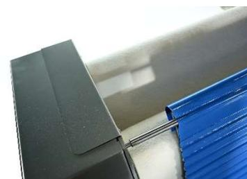
Leicht verstellbare Bandrollen für gleichmäßig geformte Teiglinge.
