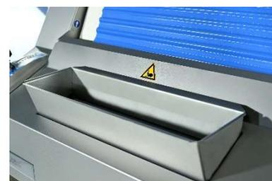
Trémie à pâte en acier inoxydable à ressort avec interrupteur de sécurité
