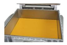
Robopress фирмы Daub создает одинаковые квадратные блоки из кондитерских изделий и масла размером 43 x 43,5 см. Машину также можно использовать в качестве пресса для дрожжевого теста.
