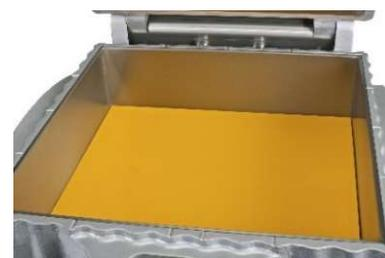
La presse Robopress de Daub crée des blocs de graisse ou de pâte rectangulaires et uniformes de 43 x 43,5 cm. Elle peut également être utilisée pour la pâte fermentée.
