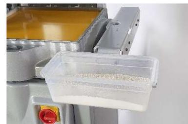
Tiroir à farine pratique et amovible avec couvercle qui peut être installé à 4 endroits différents sur la machine.
