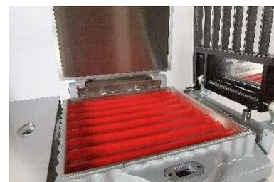
Robotrad-s Form : Diviseuses-mouleuses avec grille latérale et plaque formeuse.
