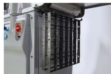
Crochets de rangement sur un ou les deux côtés de la machine pour max. 6 grilles.
