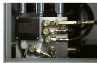
De série sur la Variomatic et une option intéressante sur les autres modèles ; régulation variable de la pression.
