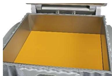
Синтетическая пригодная для пищевых продуктов пластина прессования с кольцом из нержавеющей стали рядом с кюветой для теста не требует много муки и делают Robotrad-p+ очень надежной и гигиеничной машиной.
