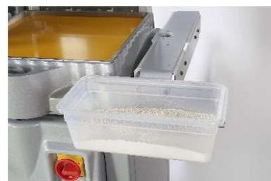
Bandeja para harina práctica y extraíble con cubierta superior que se puede fijar en diversas posiciones en la máquina.
