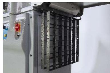
Ganchos de almacenamiento para máx. hasta 6 rejillas en uno o ambos lados de la máquina.
