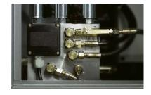
De série sur la Variomatic et une option intéressante sur les autres modèles : régulation variable de la pression hydraulique.
