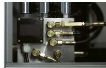
Regulación de presión variable de serie en la Variomatic para una flexibilidad máxima con una amplia gama de tipos de masa.
