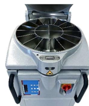
Elevación automática de la cuchilla divisora para fácil limpieza
